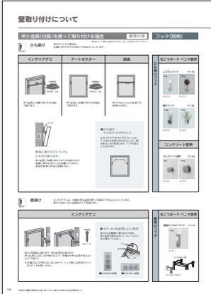
標準仕様での取り付け方法と、直掛け金具を使ってしっかり取り付ける方法を案内しています。取り付けの参考にしてください。
