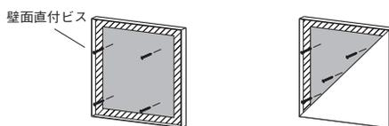
本体の前面のグリーンの間から直接壁面直付ビスで壁に固定します。
