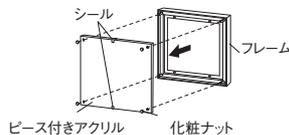
化粧ナットをまわしてははずし、ビス付きアクリルを取りはずします。(ビス付きアクリルの落下防止のため、シールで仮固定しています。破損防止のため、ビス付きアクリルはフレームに対して平行に引いてははずしてください。)
