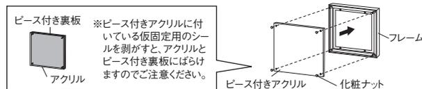
フレームにビス付きアクリルを取り付ける前に仮固定しているシールを剥がしてください。ビス付きアクリルがばらばらにならないように注意しながら、化粧ナットを締め直します。(破損防止のため、ビス付きアクリルはフレームに対して平行に押し取り付けてください。)
